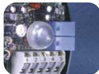
Une lentille remplace la parabole traditionnelle pour augmenter la portée et réduire la diminution des performances dues à l'accumulation de poussière
