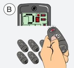
**COME AGGIUNGERE TRASMETTITORI (VIA RADIO) - HOW TO ADD TRANSMITTERS (VIA RADIO) - COMMENT AJOUTER DES ÉMETTEURS (PAR RADIO)
