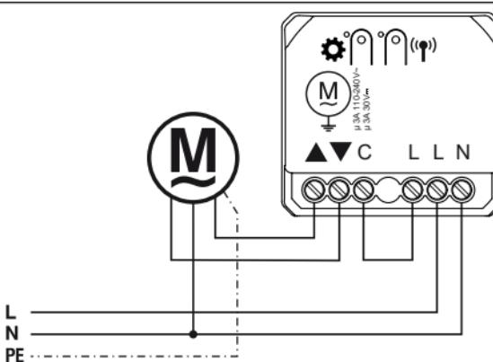
2. Lors du raccordement de la tension, l'appareil acquitte en commutant brièvement dans le sens Montée.
