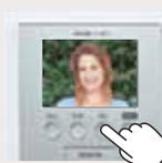
Enregistrement par appui sur le bouton REC pendant la conversation.
