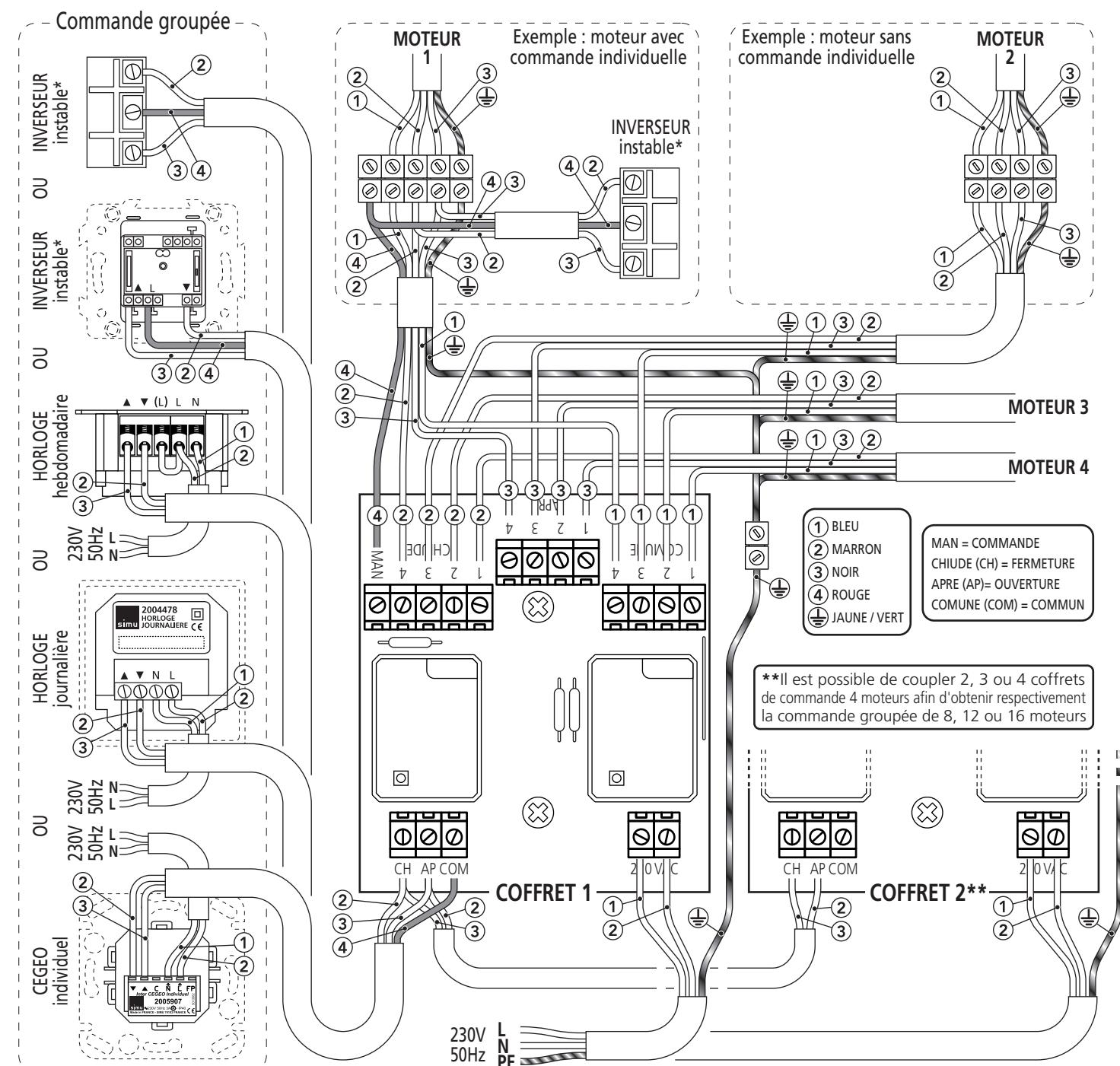
\* L'interrupteur de commande groupée peut-être de type stable si aucun des moteurs ne dispose de commande individuelle.
