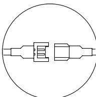
Nei modello CR10MSC la sonda è collegata al cavo tramite un connettore (v. figura).
