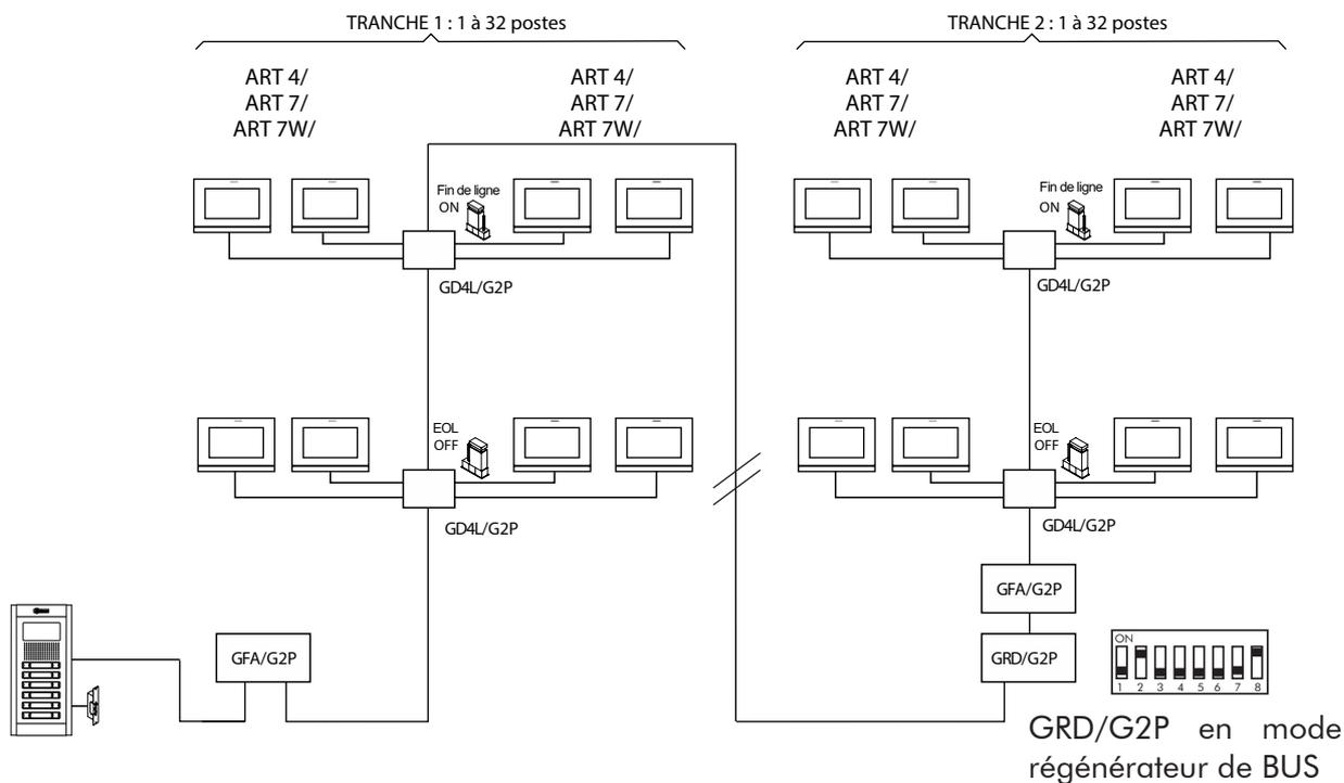
Synoptique de fonctionnement avec plusieurs colonne de moins de 32 logements :
