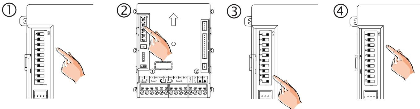
① Noter le réglage des DIP de configuration et placer tous les DIP en OFF
