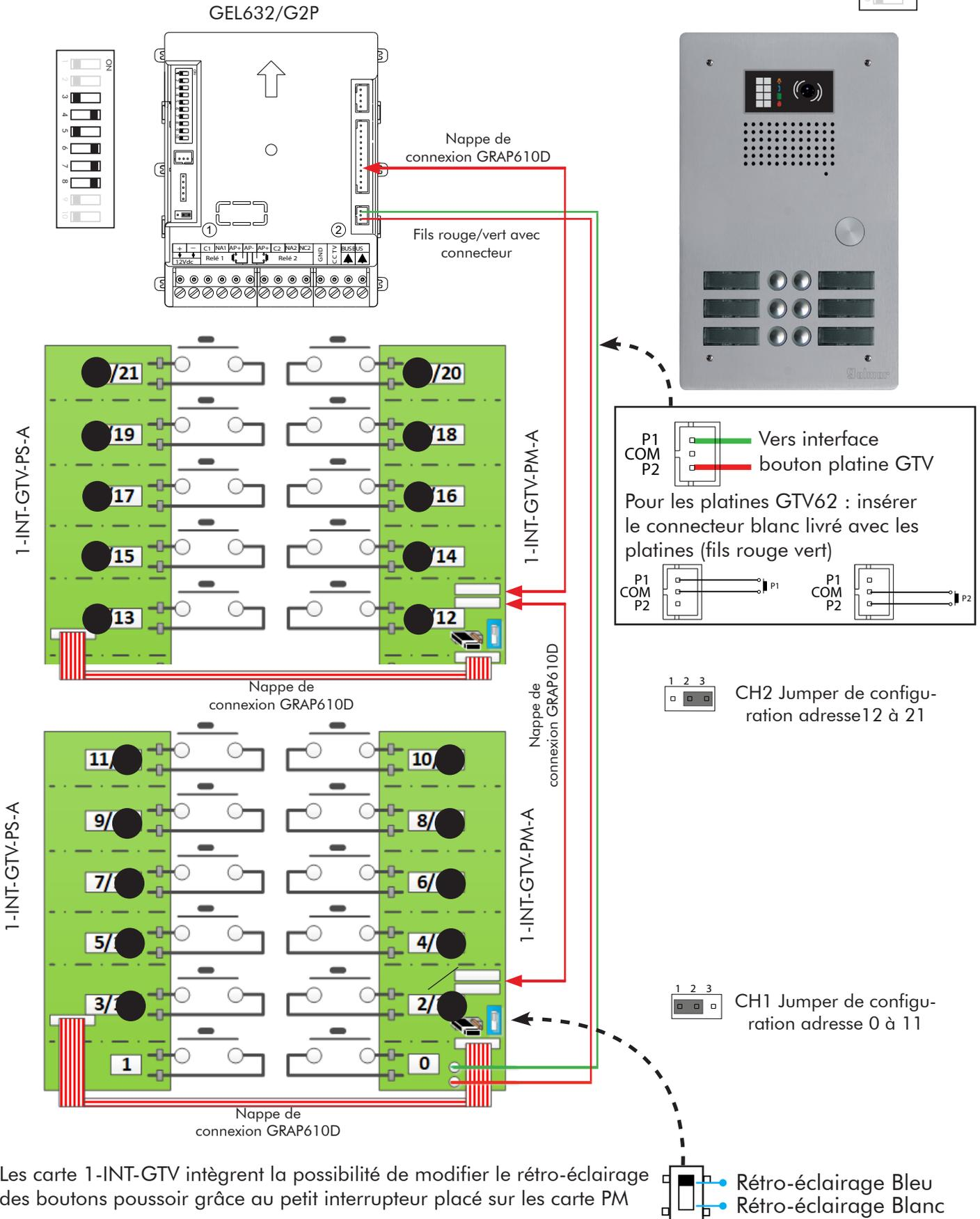
Les carte 1-INT-GTV intègrent la possibilité de modifier le rétro-éclairage des boutons poussoir grâce au petit interrupteur placé sur les carte PM
