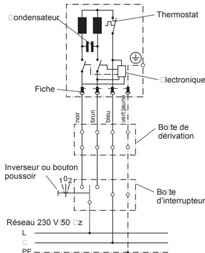
**Remarque :** Il est possible de raccorder plusieurs moteurs SunTop en parallèle. Respectez à cet égard le pouvoir de coupure maximum du point de liaison.
